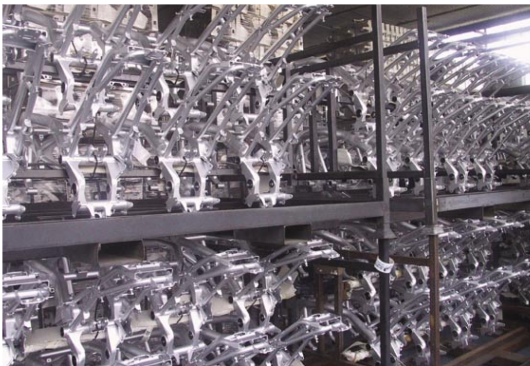
Fig. 5 - Un particolare dei filetti del telaio: gli operatori di VML ripassano a mano ogni filetto dopo il ciclo di verniciatura.
