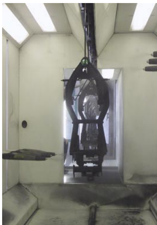
Fig. 9 - Applicazione automatica di polveri sui telai Moto Guzzi nelle cabine.
