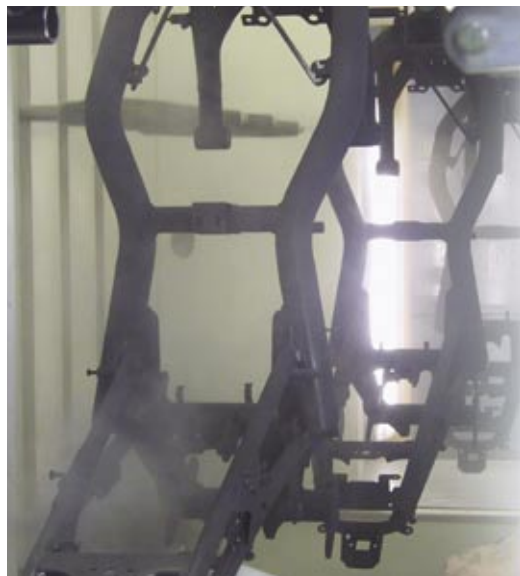
Fig. 10 - Un altro momento della finitura a polveri.
