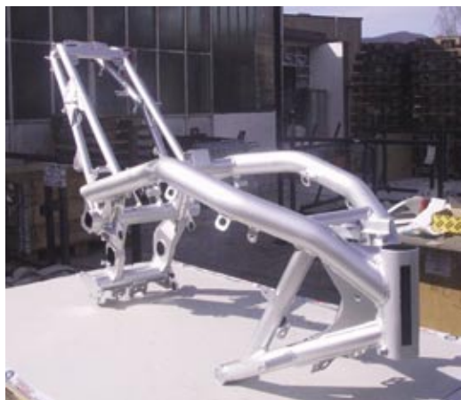
Fig. 4 - Particolare dell'applicazione delle mascherature laser ad alta temperatura, una fase essenziale per garantire la perfezione estetica del mezzo dopo la finitura.
