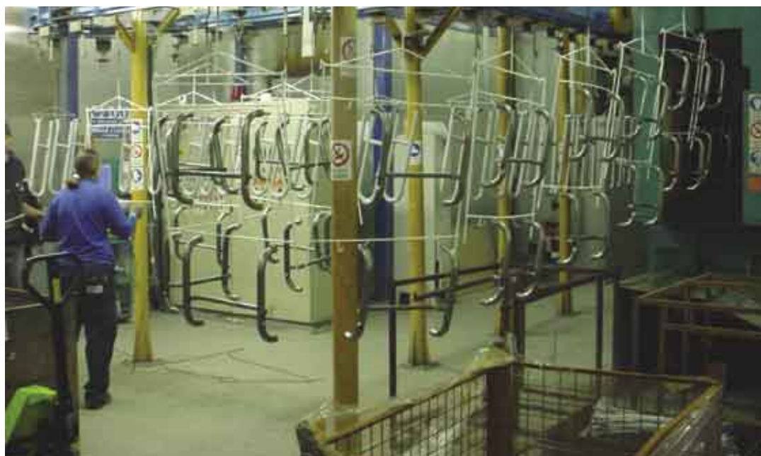
Fig. 4 - Il carico dei pezzi sull'impianto di verniciatura alla VML.
