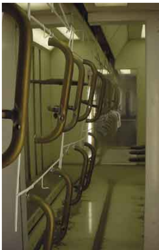
Fig. 6 - I pezzi, dopo l'asciugatura, entrano nella prima cabina di verniciatura automatica per l'applicazione del fondo autolivellante.
