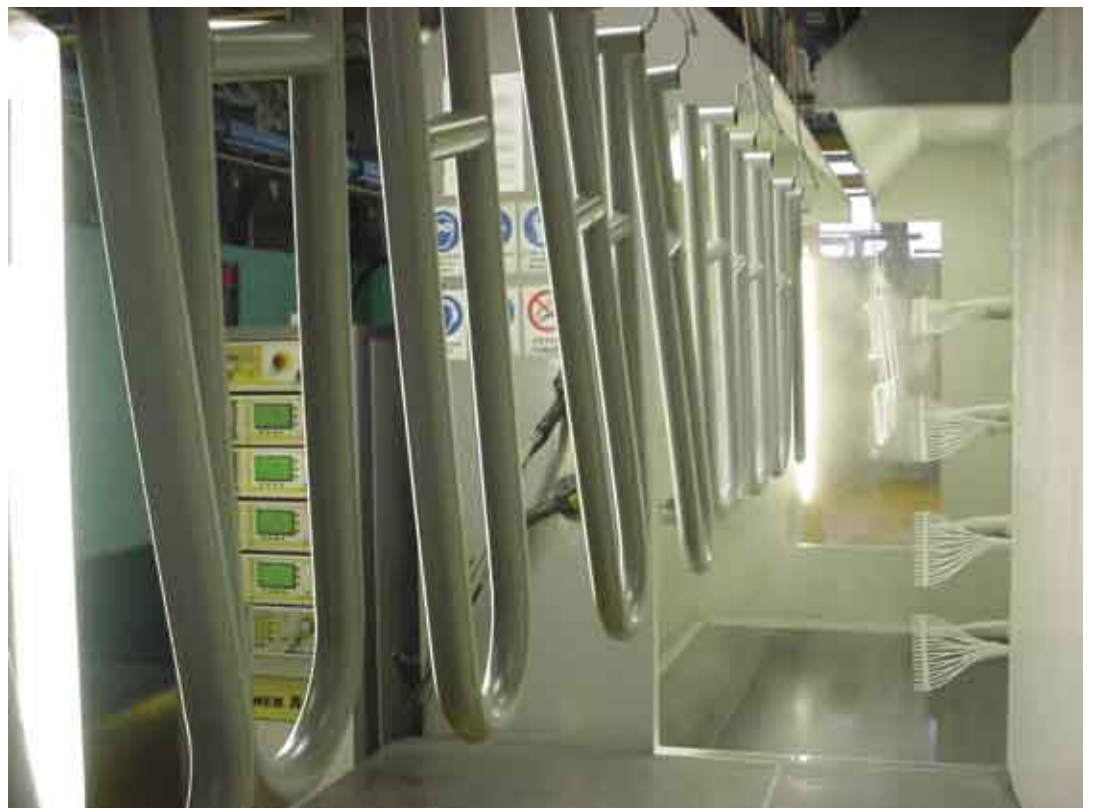
Fig. 9 - Un altro momento dell'applicazione automatica della finitura a polveri poliestere bianca superlucida, con il metodo della carica triboelettrica. Gli erogatori tubo sono visti nella destra di figura.
