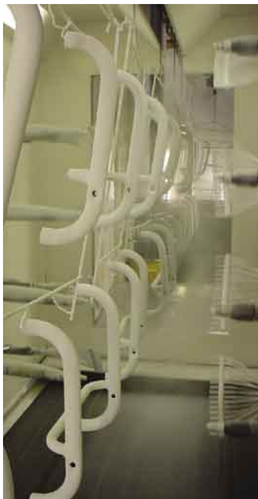
Fig. 7 - Uno dei passaggi relativi all'applicazione automatica della finitura a polveri poliestere bianca superlucida.
