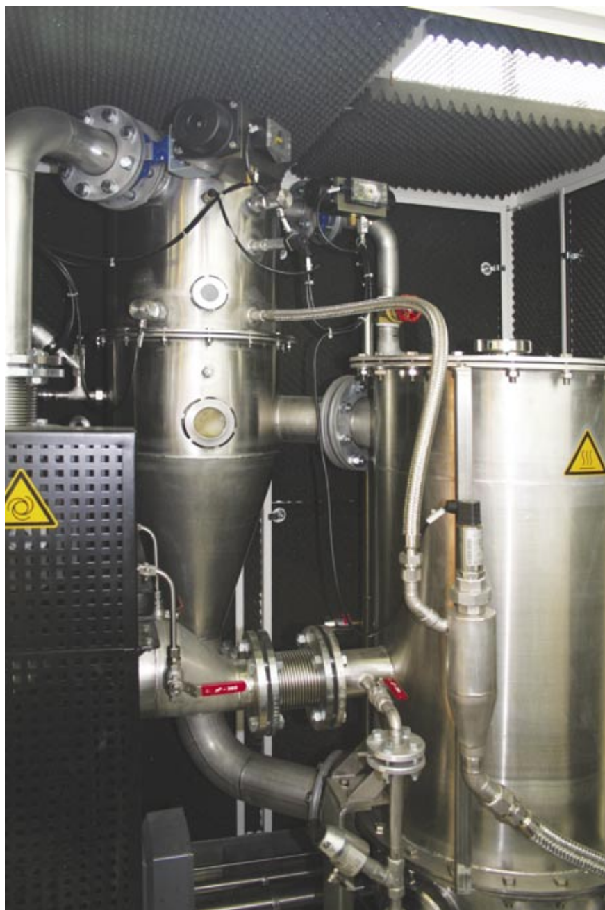
Fig. 11 (sopra) - L'evaporatore sottovuoto a compressore volumetrico Loft Destimat Low Energy
