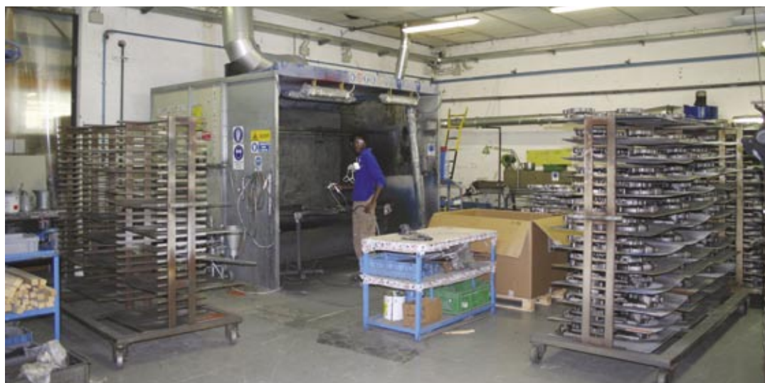
Fig. 8 (pagina a lato, in basso) - La zona di carico e l'ingresso nel tunnel di pretrattamento dell'impianto per alluminio e leghe
